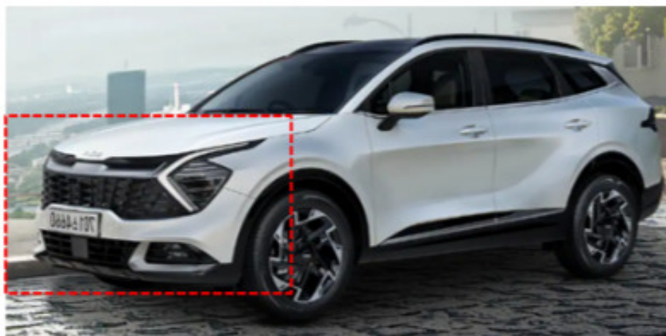
Active Air Flap 장착 위치
